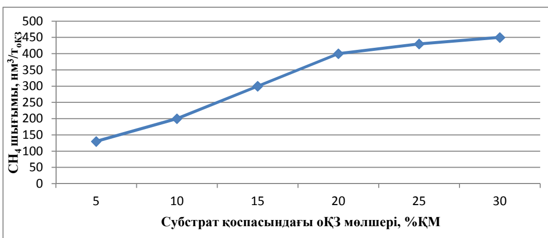
3-сурет. Субстраттық қоспадағы оҚЗ құрамы мен оҚЗ бір тоннасына CH 4 шығымы арасындағы өзара байланыс
