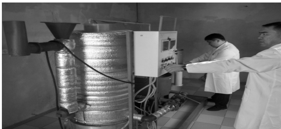
1-сурет. Биогаз алуға арналған тәжірибелік қондырғы
