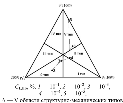
Рисунок 3. Тройная диаграмма относительных деформаций системы КГ-ЦПБ
