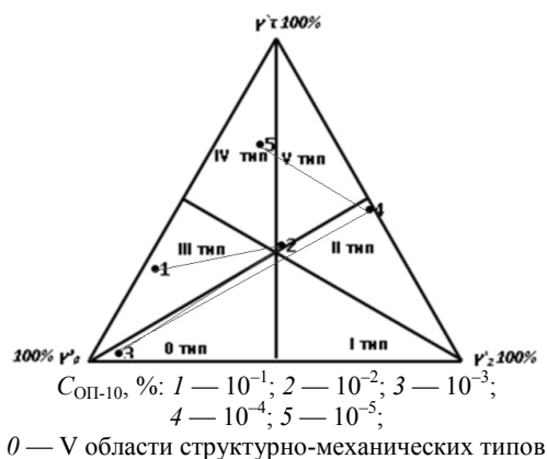
Рисунок 4. Тройная диаграмма относительных деформаций системы КГ-ОП-10
