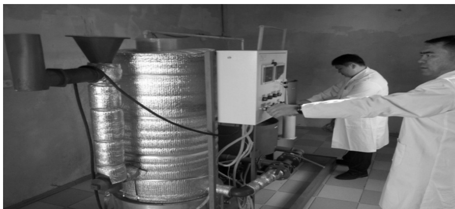
1-сурет. Биогаз алуға арналған тәжірибелік қондырғы
