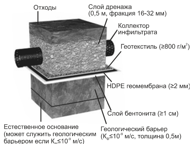
Рисунок 1. Конструкция основания полигона
